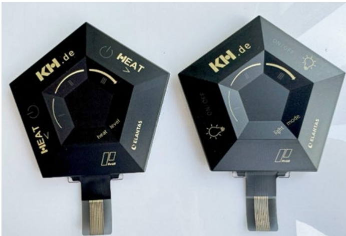
Bild 2: Funktionales IMD/FIM-Demo-Bauteil von KH-Helmbrechts. Nichtleitende IMD/FIM-Farbsysteme werden zum Vordruck und Hinterlegen der gedruckten Leiterbahnen eingesetzt.
