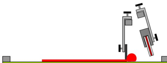
Durch diese Verfahrensweise sind kurze Druckpausen bis 3 Minuten, z. B. zur Kontrolle des Andrucks, ohne Siebreinigung möglich.
