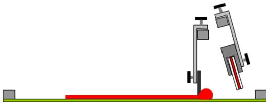
Zum Befüllen der Schablone Haftvermittler dick (1 – 2 mm) über das Sieb ziehen.
