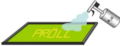
Die Schablone feuchtet man vor Druckbeginn mit Wasser an. Dadurch wird dem Haftvermittler kein Wasser entzogen, er kann die Farbkanäle ohne Antrocknen passieren.
