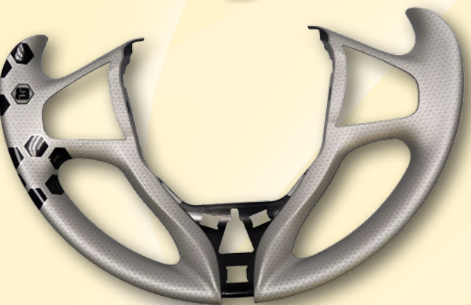
Automotive Dekorblenden, transparente PC-Folien sind vorderseitig mit dem UV-stabilisierten Dual-Cure-Lack Norilux® DC überdruckt. Das Dekor wurde mit der IMD/FIM Siebdruckfarbe NORIPHAN® HTR N auf die Folienrückseite gedruckt. Anschließend wurden die gedruckten Farbschichten mit PC/ABS direkt hinterspritzt.
