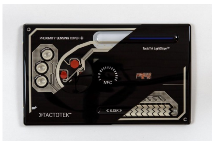
Bild 2-3: Tactotek IMSE-3D-Demo-Blenden, leitfähige Pasten werden rückseitig mit NORIPHAN® XMR überdruckt
