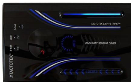
Bild 2-3: Tactotek IMSE-3D-Demo-Blenden, leitfähige Pasten werden rückseitig mit NORIPHAN® XMR überdruckt
