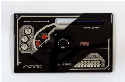
Bild 1: Tactotek IMSE-3D-Demo-Blenden, leitfähige Pasten können rückseitig mit NORIPHAN® HTR N 990 NC überdruckt
